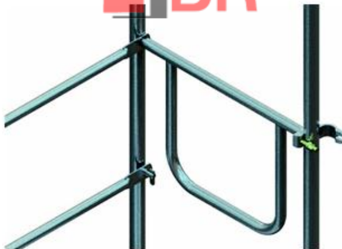
Rys. 24. Montaż poręczy poprzecznej
