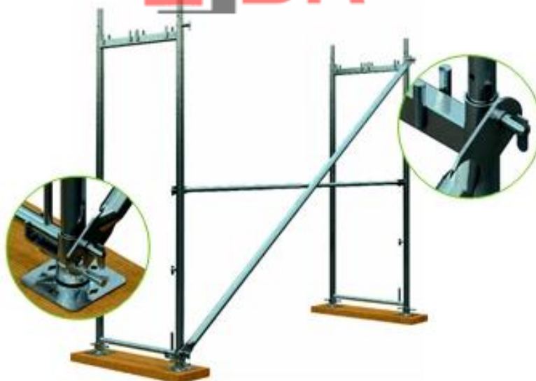
Rys. 5. Montaż stężenia ukośnego pierwszego pola
