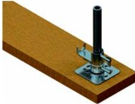
Rys. 3. Montaż dolnego mocowania stężenia na podstawkę śrubową
