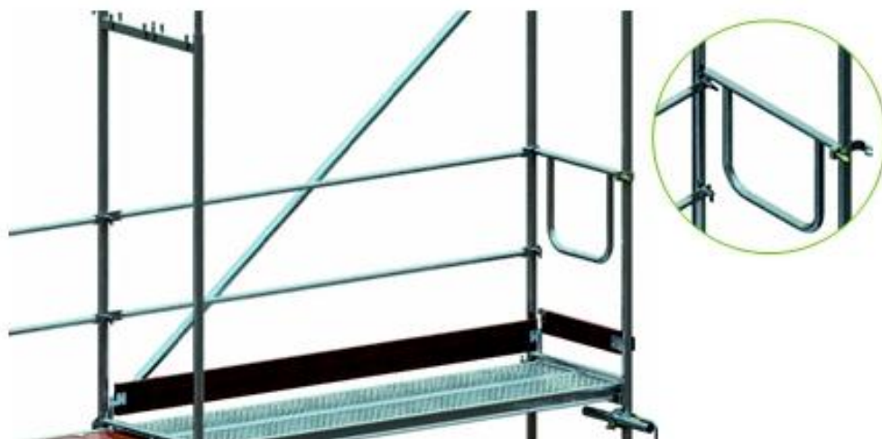
Rys. 14. Montaż poręczy poprzecznych i desek burtowych
