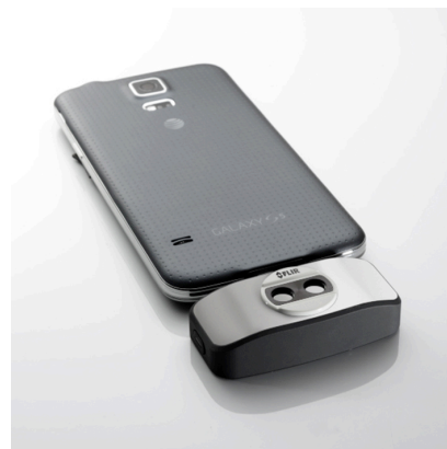
Rysunek 14.3 2015 r.: FLIR One, kamera dla smartfonów iPhone i z systemem Android. Waga: 90 g.
